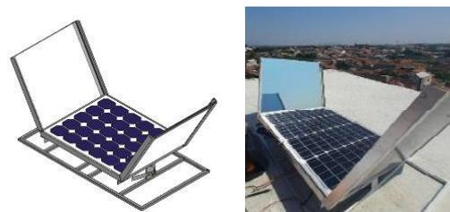
Gambar 3. Kerangka dan Reflektor Modul surya
