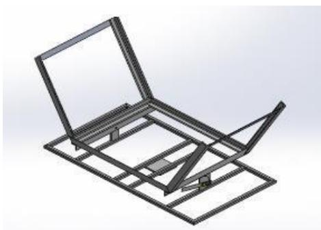
Gambar 2. Rangka modul surya
