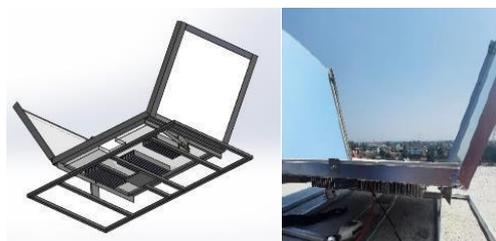
Gambar 4. Posisi box pendingin dan heat sink
