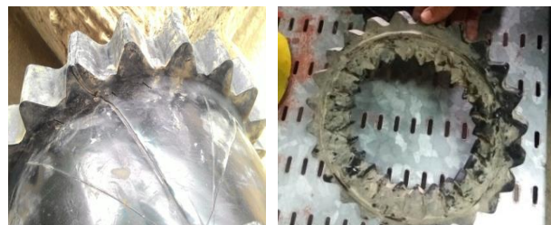
Gambar 16. Bentuk Kerusakan pada Kopling Karet
