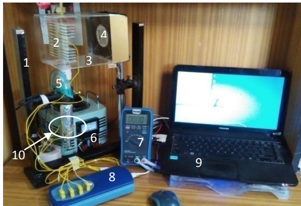
Gambar 3. Peralatan pada pengujian pipa kalor (Iskandar, 2017)
