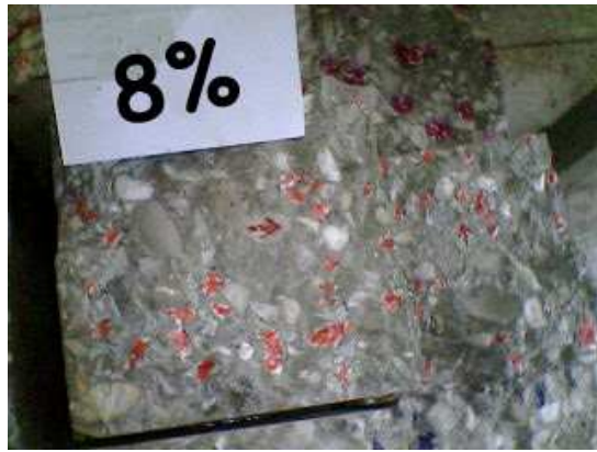
Gambar 6. Penyebaran styrofoam pada persentase 8%
