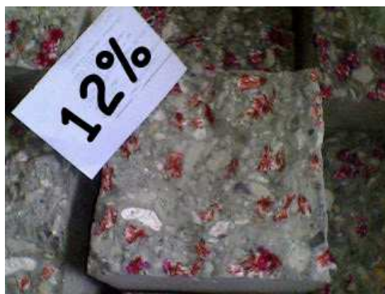
Gambar 7. Penyebaran styrofoam pada persentase 12%
