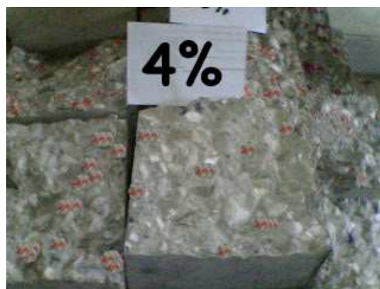
Gambar 5. Penyebaran styrofoam pada persentase 4%
